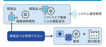
IoTシステムは、物理現象を捉える仕組みのデバイス選定が重 要。検証段階では既製品を利用し、実運用段階では、既製品 の利用可否を検討。必要に応じてデバイスや周辺機器をカス タム開発・製造して組み合わせて提供します。
