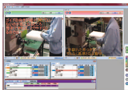
比較検証機能：初心者、熟練者の作業映像を比較再生し、「技術伝承」から「作業指示」まで利用可能
