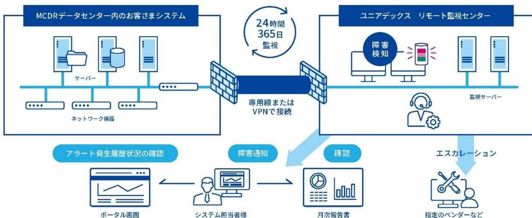
リモート監視サービスは、ユニアデックスのリモート監視センターから、MCDR のデータセンター内に構築された、お客さまのサーバーやネットワーク機器を 24 時間 365 日、常に遠隔で監視し、システムの安定稼働を支援するサービスです。
